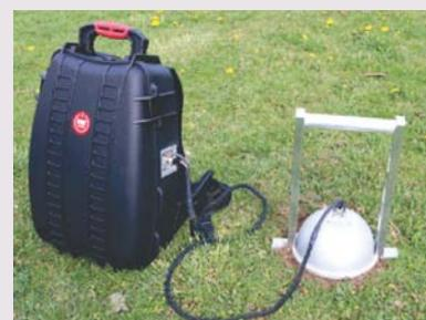
**Echo (Halle A3, Stand 512)** präsentiert ein tragbares Gerät für die simultane Messung von Kohlenstoffdioxid, Schwefelwasserstoff, Methan, Sauerstoff, Kohlenwasserstoffen und anderen Bodengasen. Verschiedene Sensoren messen die Gaskonzentration über einen dynamischen Bereich. Ein integriertes GPS-Modul bestimmt den genauen Standort der Messung. Über Bluetooth ist das System mit mobilen Endgeräten verbunden.
